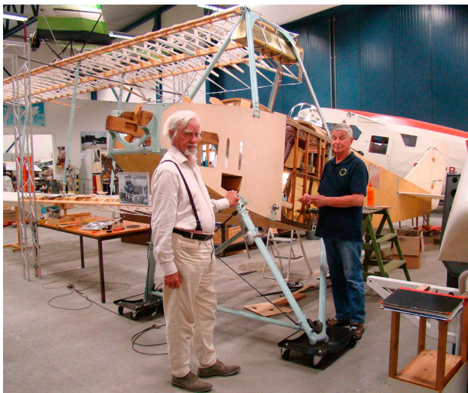
Två herrar som under många år varit engagerade i restaureringen av Albatros, är Börje Holmberg och Bengt Emilsson. Arbetet är grannlaga, det är inte alltid gamla ritningar stämmer och då måste kvalificerade gissningar till. Dukningen av vingarna är tidsödande och kräver stor noggrannhet.
