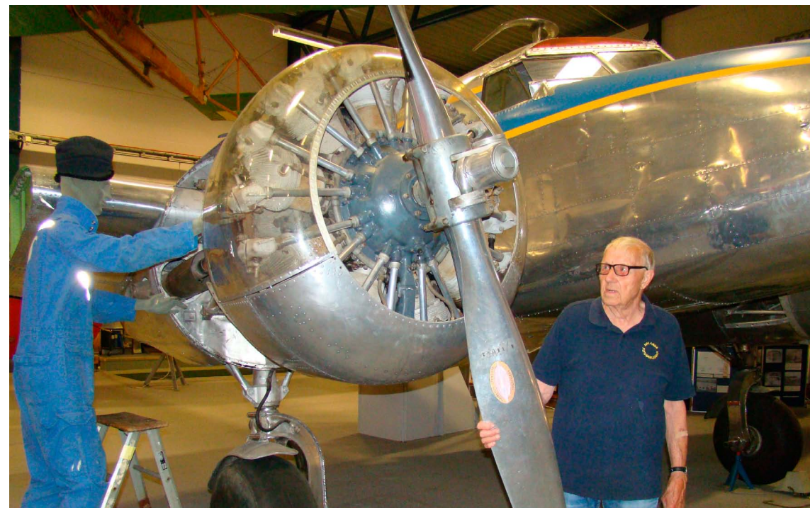
Per Sviberg är en av dem som lagt ner mycket arbete på att restaurera samlingarnas Lockheed Electra. Motorkåpan på högra motorn är gjord i formgjuten genomskinlig plast så att besökarna dels ser kåpans konturer, dels innanmätet. Det är en fiffig innovation som volontärerna själva kommit på och som säkert kommer att få spridning.
