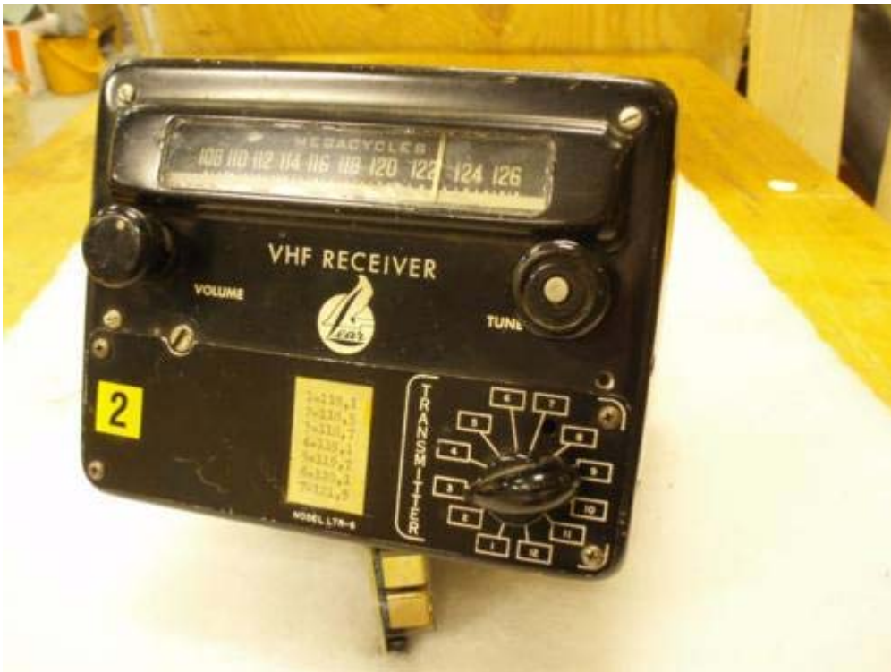
FLYGRADIO LEAR Modell LTR-6 Tillv år 1955. 11 radiorör.plats för 12 st sändarekristaller.Mottagare manuellt avstämbar.Användes bl.a i Sea-Bee. Från Hallins Flygradio/Torslanda/Säve
