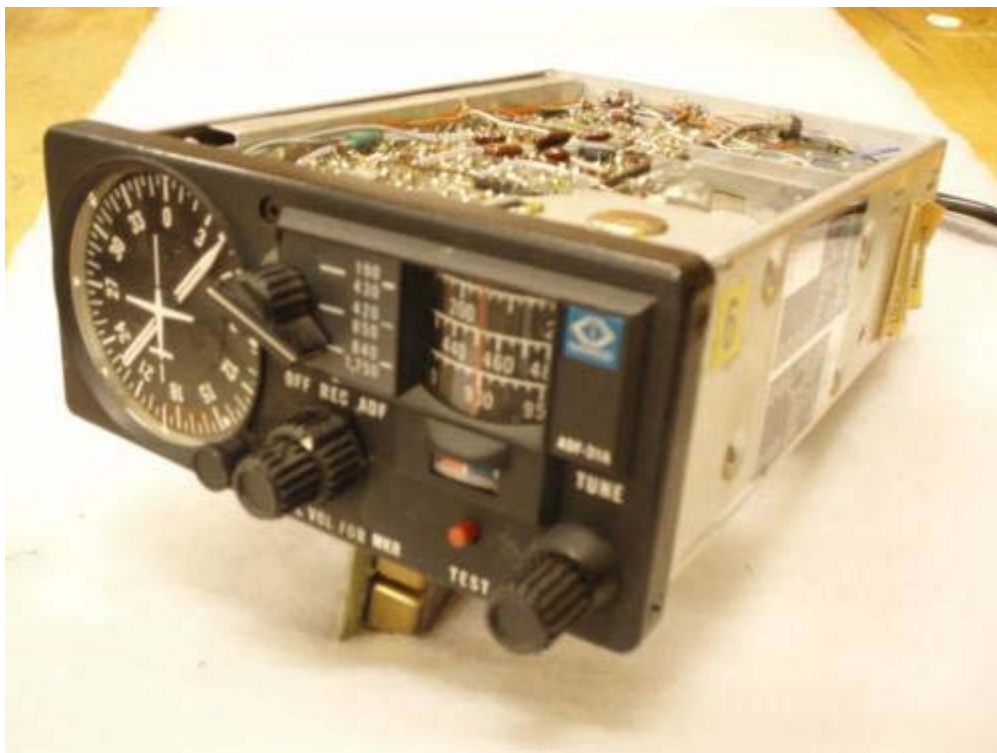
Radiopejl ADF ( Automatic Direction Finder) Typ: NARCO ADF -31A
