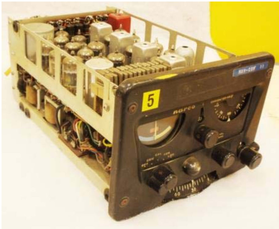
FLYGRADIO NARCO Omnigator - MK2 Drives med Modulator-Kraftenhet V12-MP-2A
