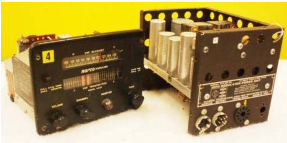
FLYGRADIO NARCO SIMPLEXER VC-27 Med Modulator-kraftenhet V12-MP-2a Manuell avstämning av mottagaren. 27 fasta kristaller för sändaren Tonsignal för exakt inställning av mottagaren med hjälp av sändarekristallen. "Pull Xtal Tune" 13 rör, vibratoromformare för att erålla anodspänning. Vanlig i Piper och Cessna Tillverkad 1958 Från SE-CLP Kalle Kristiansen Torsby Urmonterad:Lars Hallin 1973 Fornebu Oslo.
