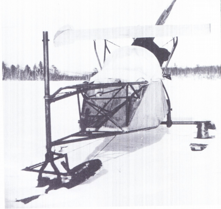
Denna bild visar den styrbara stjärtskidan och roderlinorna samt den lilla vingen med bränsletank innuti. Foto via Gaston Sundgren.
