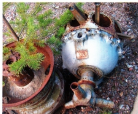
De svårt korroderade resterna av en Wright Cyclone R-1820-97-stjärnmotor. Motorn återfanns i Norrtälje i mitten av 70-talet. Foto Jan Forsgren.
