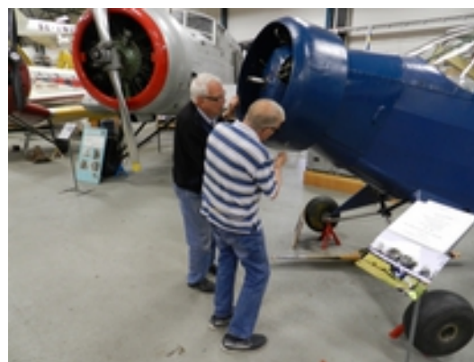
Kurt Ivarsson och Per Sviberg monterar motorkåpan på SE-AHD. Foto: Jan Forsgren Efter att ovannämnda arbeten har utförts, återstår målning av vingarna samt montering. Vår GV-38 kommer verkligen att pryda sin plats i samlingarna!
